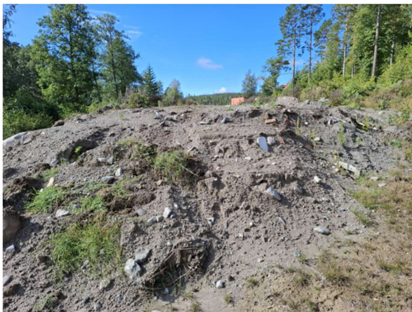
Bild 15. Foto taget på den norra kortsidan av utfyllnaden. Längst ut mot vattnet är den ca 1,6 – 1,9 m mäktig och avtagande inåt land.
